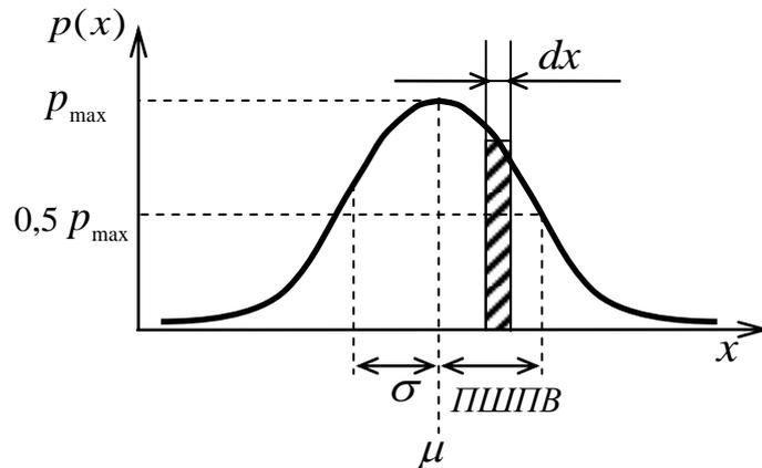
Вероятность  $P(x_1, x_2)$  попадания результата в конечный интервал  $[x_1, x_2]$  находят интегрированием плотности распределения:
