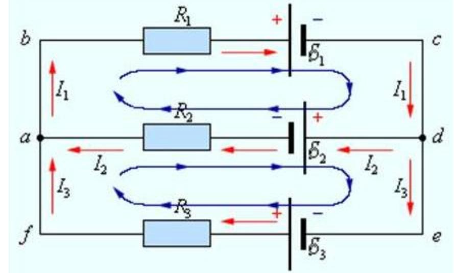
В любом замкнутом контуре, произвольно выделенном в разветвленной электрической цепи, алгебраическая сумма падений напряжений на участках контура, равна алгебраической сумме ЭДС.
