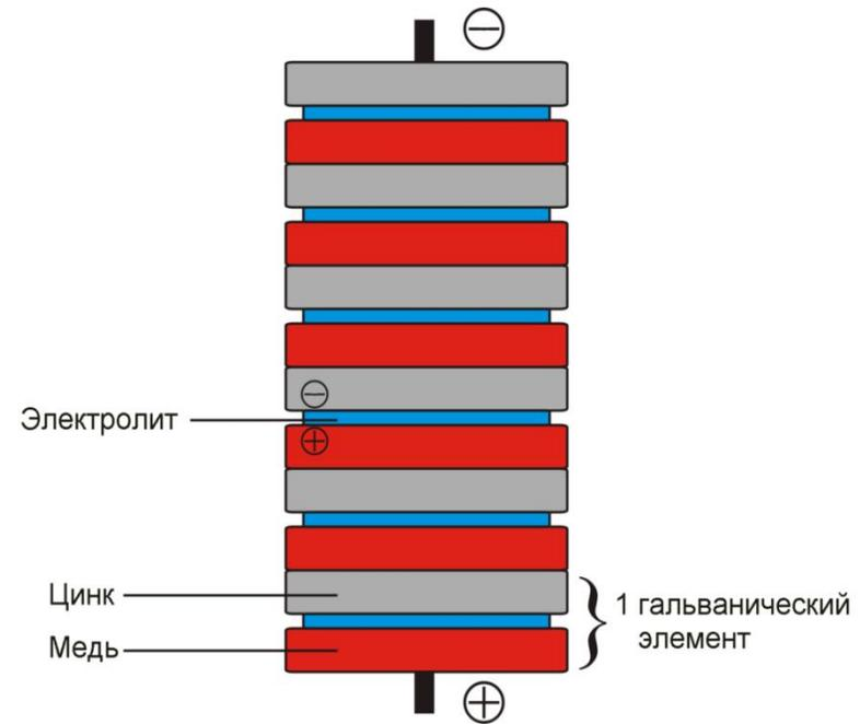
Химический источник тока –устройство, в котором энергия химических реакций превращается в электрическую энергию. Первый химический источник тока – вольтов столб.
