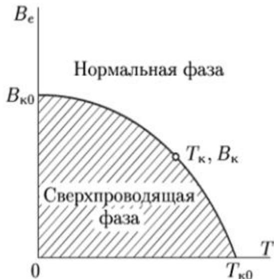
Для заданной температуры повышение поля приводит к разрушению сверхпроводимости. Поле, при котором это происходит, называется критическим.
