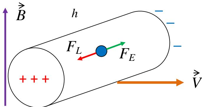
Сила Лоренца перераспределяет заряды в проводнике, движущемся в магнитном поле. На концах такого проводника появляются индуцированные заряды. Эти заряды создают электрическое поле, и, следовательно, между концами проводника возникает разность потенциалов.
