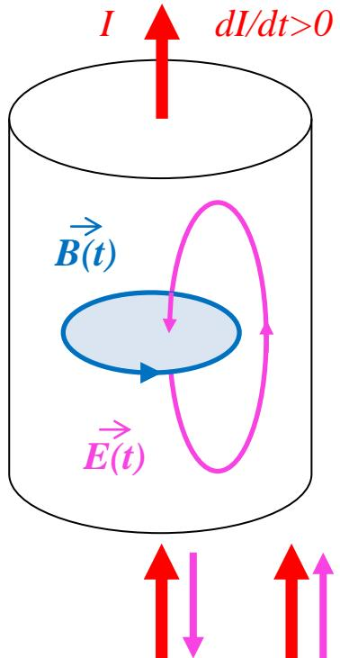
Вследствие возникновения вихревых токов высокочастотный ток вытесняется на поверхность проводника. Этот эффект носит название скин-эффекта. Высокочастотные провода делают полыми.
