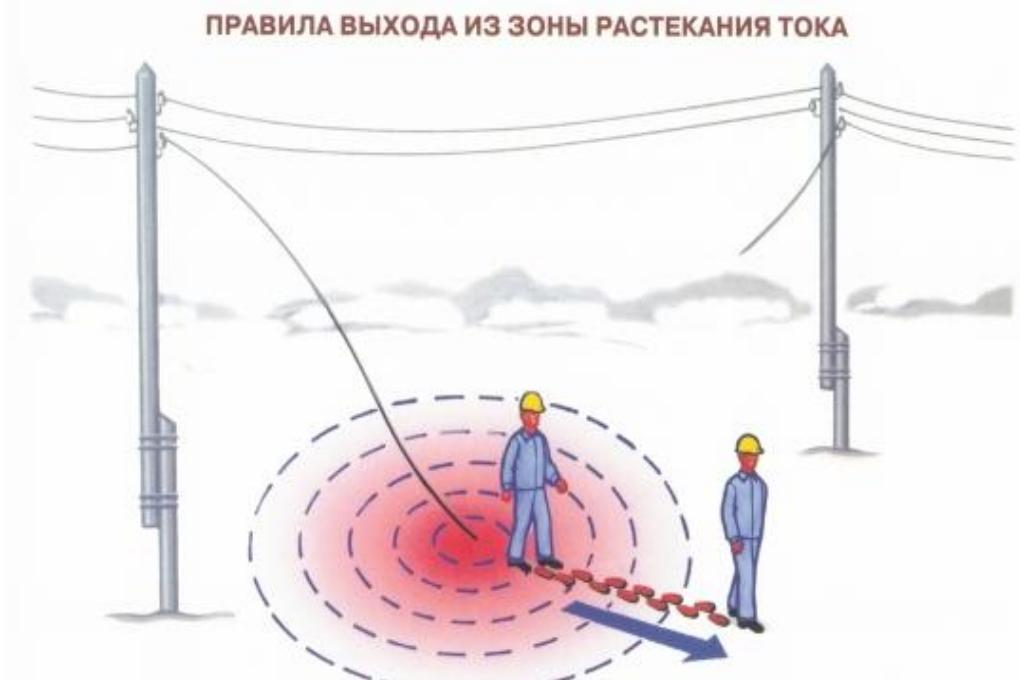
Если токоведущий элемент лежит на земле, возникает опасность напряжения шага. При отсутствии защитных средств выходить из зоны растекания тока следует короткими шагами, растекания тока, используйте диэлектрические передвигая ноги без отрыва их от земли и одной ступни галоши и коврики, сухие доски.
