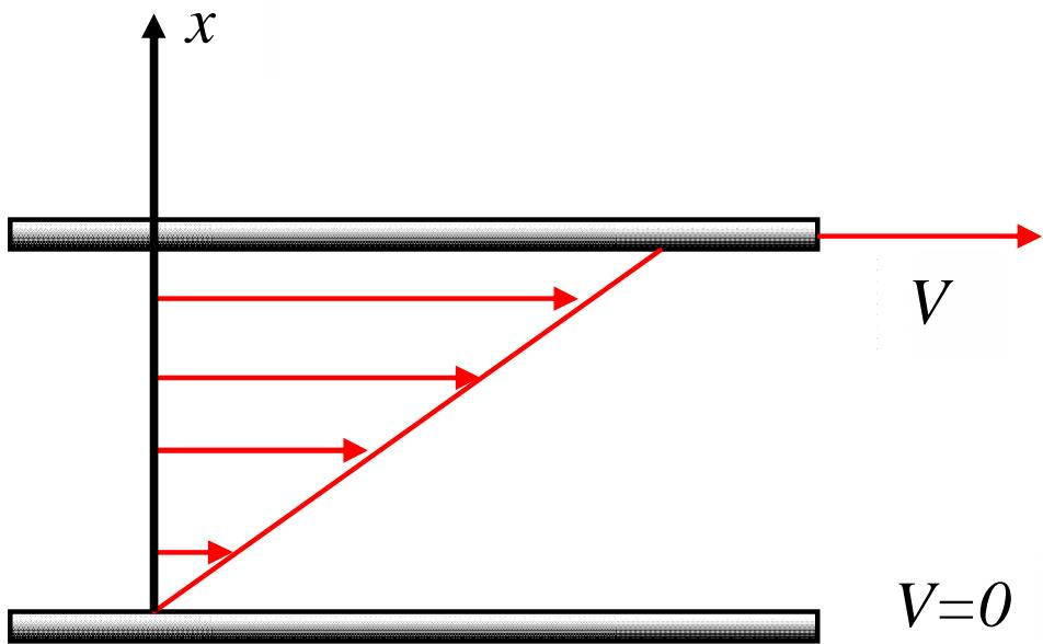
Газ расположен между двумя пластинаами. Нижняя покойится, верхняя движется. Пластиинка увлекает за собой прилегающий слой газа, а тот, в свою очередь, увлекает нижележащий слой. Весь газ можно разделить на тонкие слои, движущиеся с разными скоростями. Слой, прилегающий к нижней пластинке, неподвижен.
