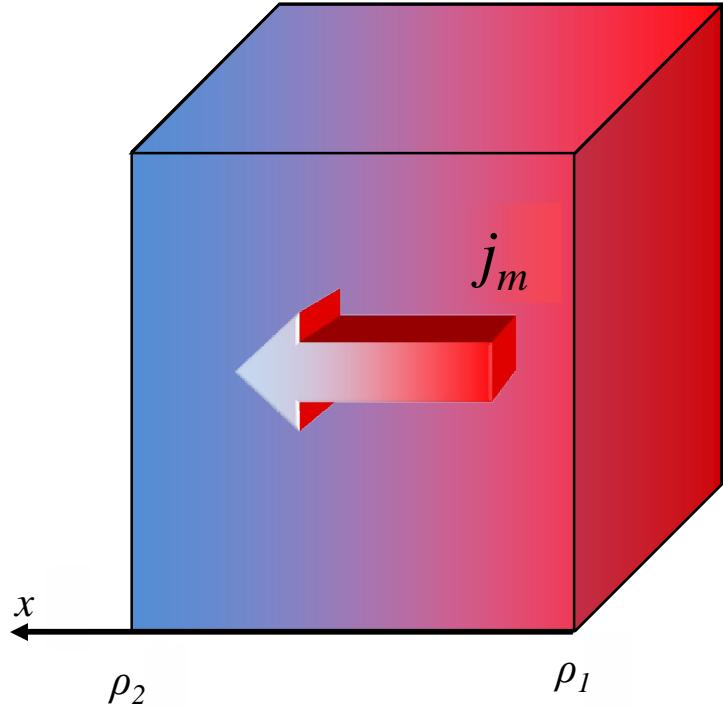
Диффузия происходит в направлении уменьшения концентрации вещества и приводит к равномерному распределению вещества по занимаемому объему. Диффузия наблюдается в газах, жидкостях и твёрдых телах.
