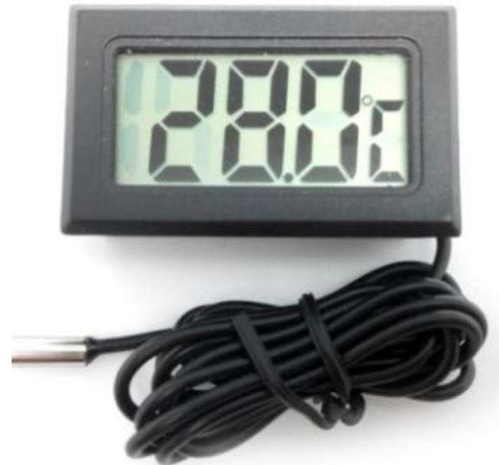
Если прибор имеет дискретную индикацию, то инструментальная погрешность равняется минимальной цене деления.
