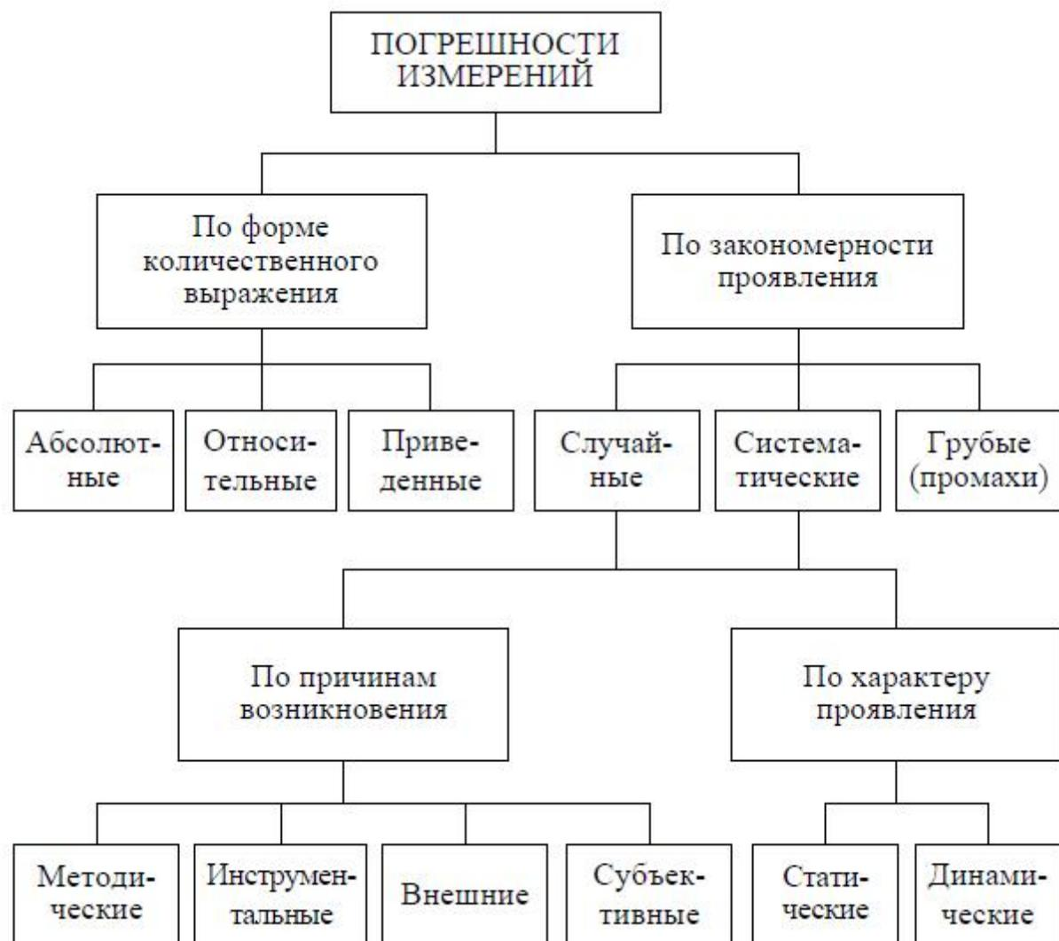
Инструментальная погрешность простого стрелочного прибора равняется половине минимальной цене деления.
