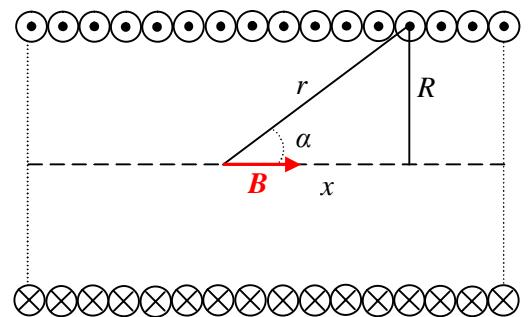
Выделим один виток как показано на рисунке. Определим индукцию в точке, находящейся на оси на расстоянии  $x$  от плоскости витка. Расстояние от проводника до выбранной точки обозначим  $r$ . Индукция  $B$  на оси кругового витка с током определяется выражением
