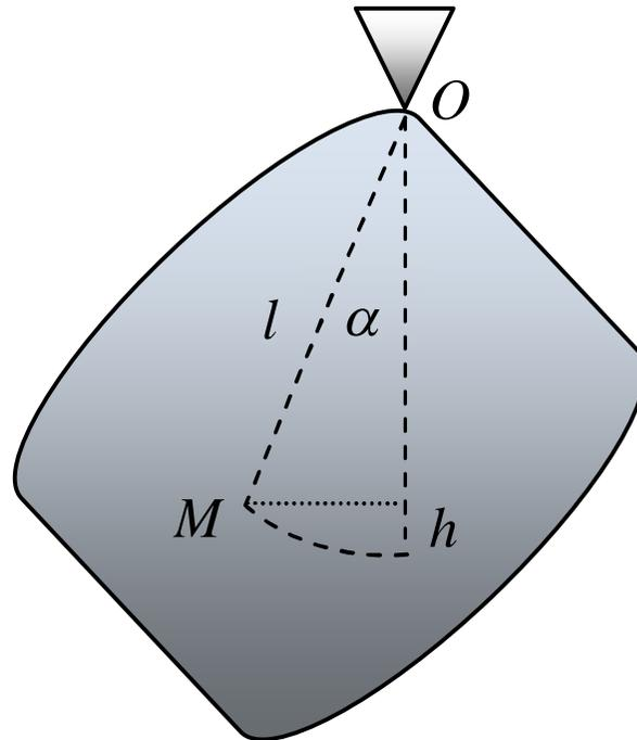
Физический маятник - твердое тело, совершающее колебания под действием силы тяжести вокруг неподвижной горизонтальной оси, не проходящей через центр масс.
