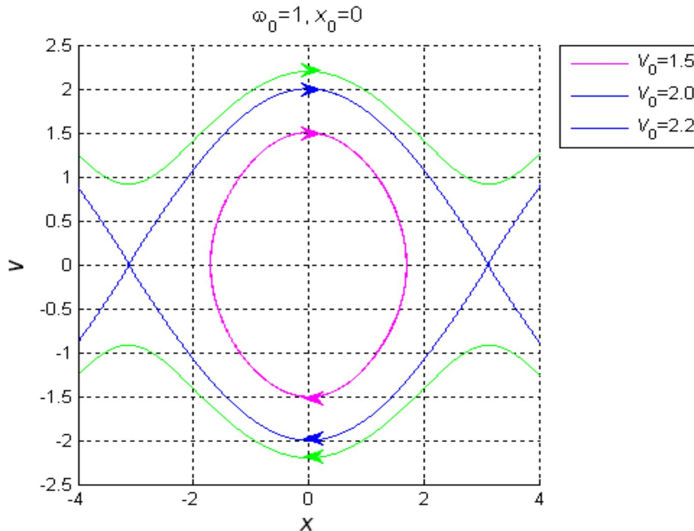
Сепаратриса – траектория, разделяющая фазовую плоскость на области, соответствующие разным типам движения.
