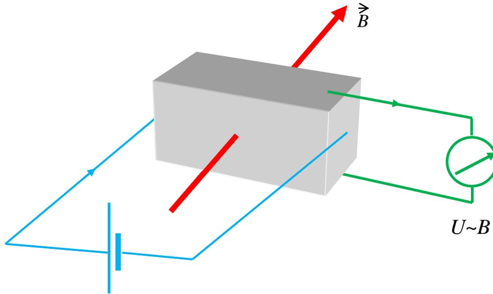
Эффект Холла — возникновение поперечной разности потенциалов в проводнике с постоянным электрическим током в магнитное поле.
