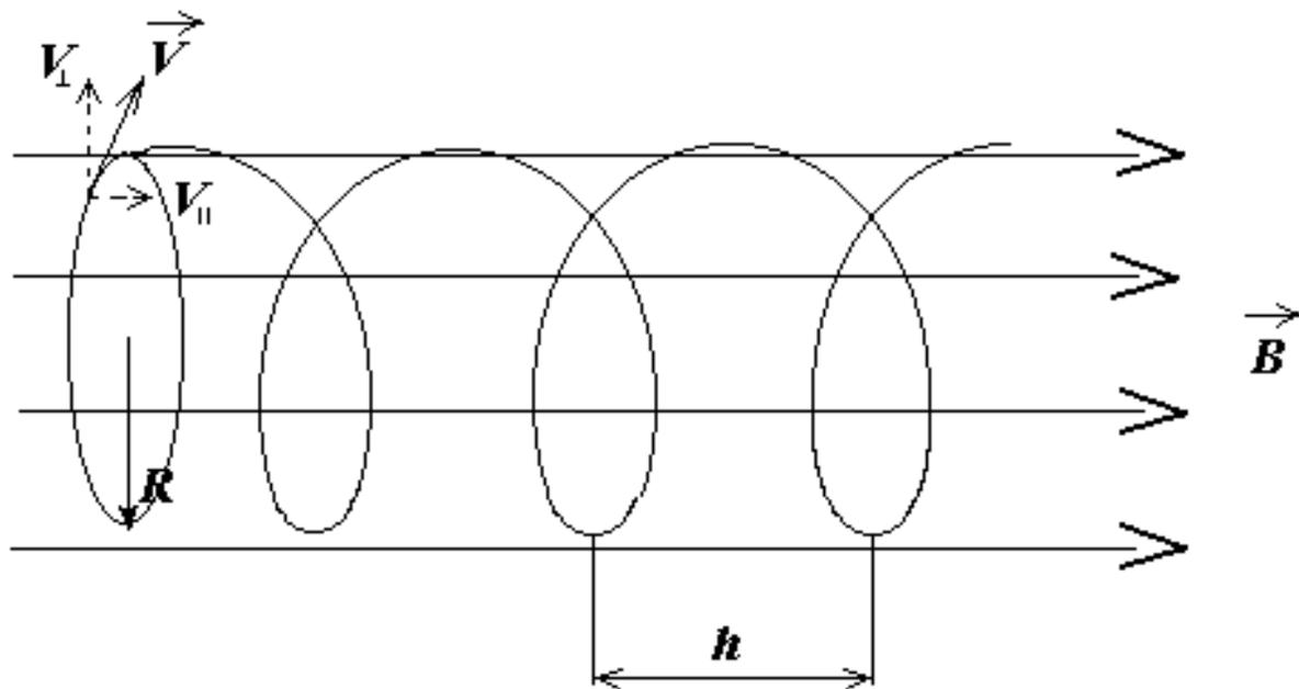
Заряженная частица накручивается на линию магнитной индукции.
