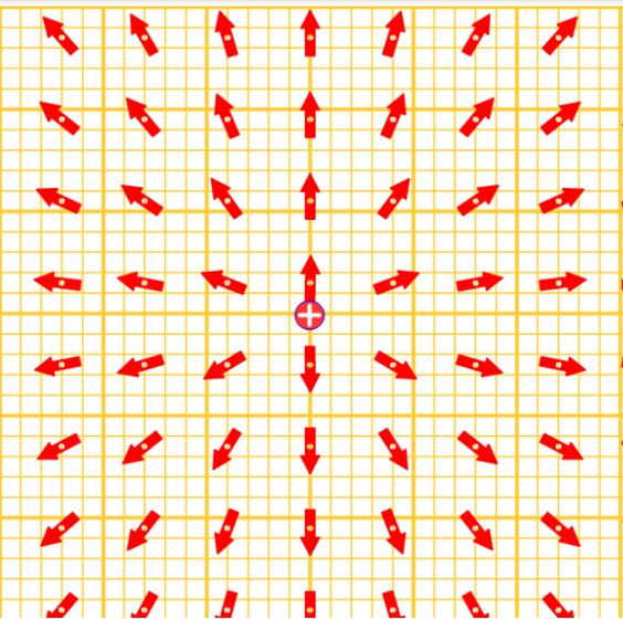
Силовая линия (линия напряженности) - воображаемая линия, касательная к которой в каждой точке совпадает с направлением вектора напряженности.
