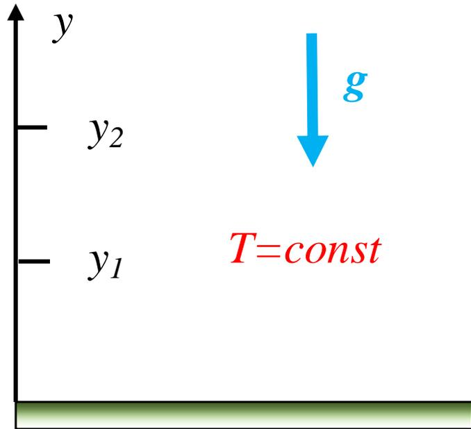
$$P = \rho gh \quad \text{гидростатическое давление}$$
